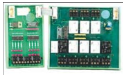
Montage en « bus » d'une carte 8 entrées et d'une carte 8 sorties relais
