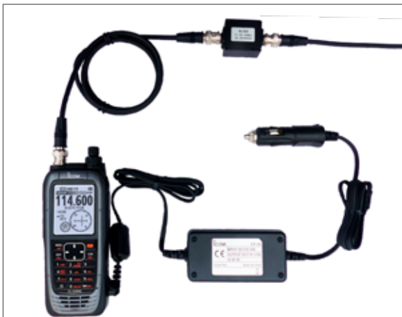
Radio aviation livrée avec Filtre FL-IFFM2*, alimentation CP-20 et câble BNC (1 mètre)
