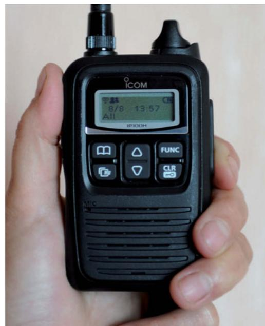
contrôle le système est également nécessaire. Le réseau ainsi constitué fonctionne avec des transceivers portatifs spéciaux dénommés Icom IP100H.
